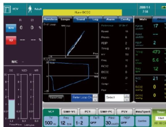
Измерение давления в дыхательных путях, потока, объема, параметров соответствия и сопротивления в реальном времени помогает легко обнаруживать утечки, обструкцию дыхательных путей и оптимально регулировать параметры вентиляции
